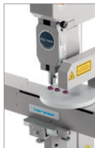
Lasergesteuerte Positionierung von O-Ringen
