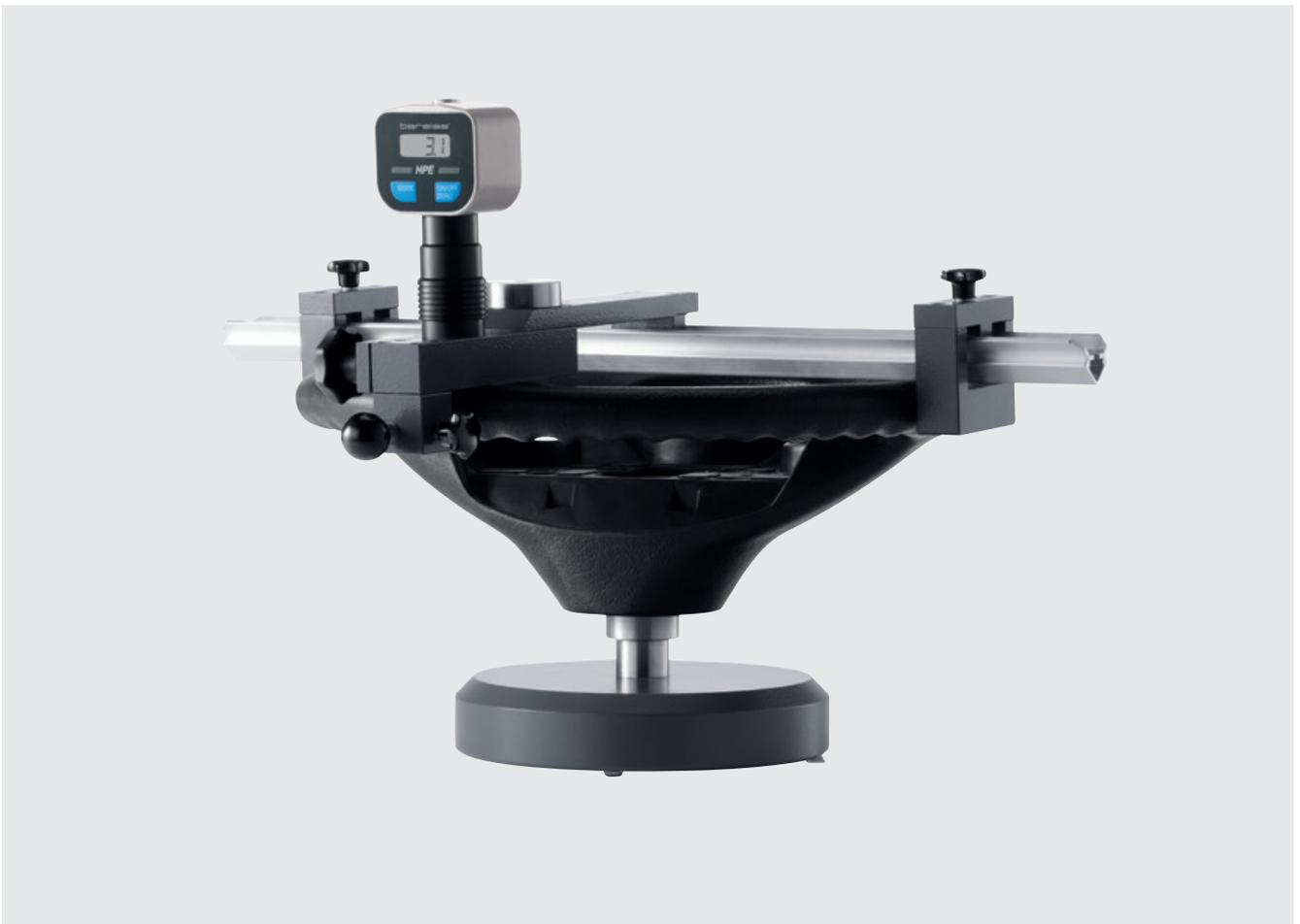
Zur Ermittlung der Härte geschäumter Materialien von KFZ-Lenkrädern mit Kunststoff- oder Lederüberzug nutzen Sie unser HPE II L/c. Mit seinem kurzen Messweg und der kleinen 5-mm-Eindringkugel ist dieser digitale Handhärteprüfer speziell auf dünne Materialauflagen ausgelegt.
