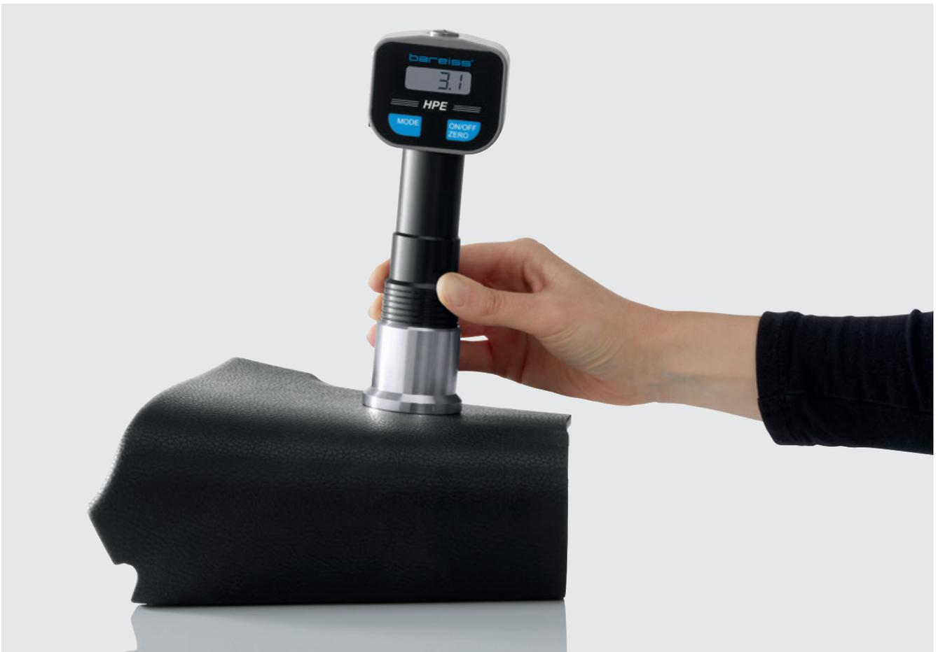
Die Härte geschäumter Materialien von großflächigen Teilen der KFZ Innenausstattung mit Kunstlederabdeckung überprüfen Sie direkt am Fertigteil mit dem KFZ-Interieur. Durch den Bareiss-Handgriff mit Anpresshülse und den integrierten Sockel lässt sich der digitale Handhärteprüfer sicher auf dem Prüfling aufsetzen und gleichmäßig anpressen. Mit seiner etwas größeren Eindringkugel von wahlweise 10 oder 15 mm ist der KFZ-Interieur für die Härtemessung an fein- bis mittelporigen Schäumen ausgelegt.
