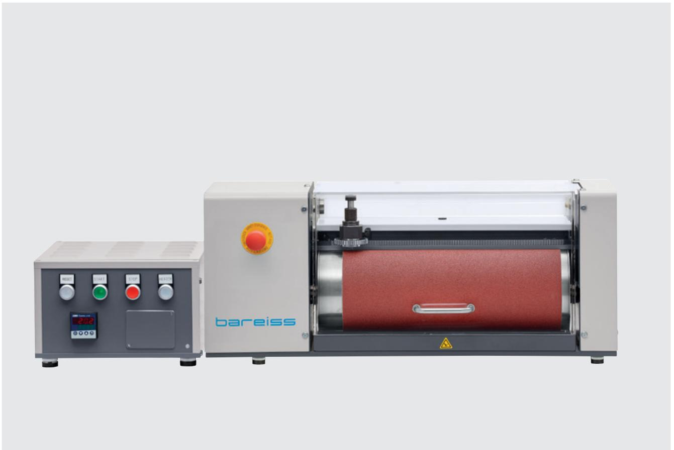
Mit der Abriebprüfmaschine bestimmen Sie die Abriebfestigkeit von Elastomeren durch Messung des Materialverlusts bei abrasiver Belastung. Das Prüfgerät führt die, je nach Modus, starre oder rotierende Materialprobe mit definiertem Anpressdruck über einen umlaufenden Schmirgelbogen und setzt sie damit einer reibenden Beanspruchung aus.
