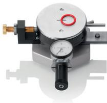
**Barofix Schnellzentriereinrichtung mit Niederhalter und Auflageplatte für O-Ringe.** Der Barofix positioniert und fixiert kleine oder große O-Ringe für Einzelmessungen.
