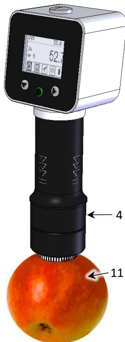
Abb. 7 Ermittlung der Fruchtfleischfestigkeit an Obst
