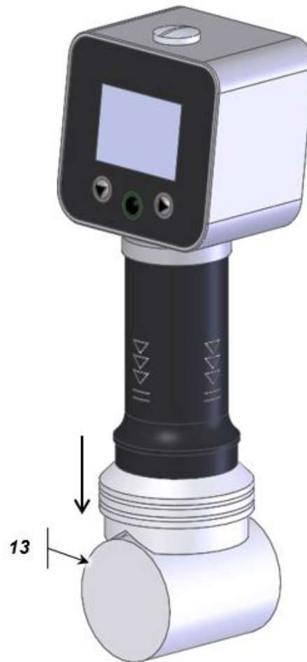
Härteprüfung mit Prisma
