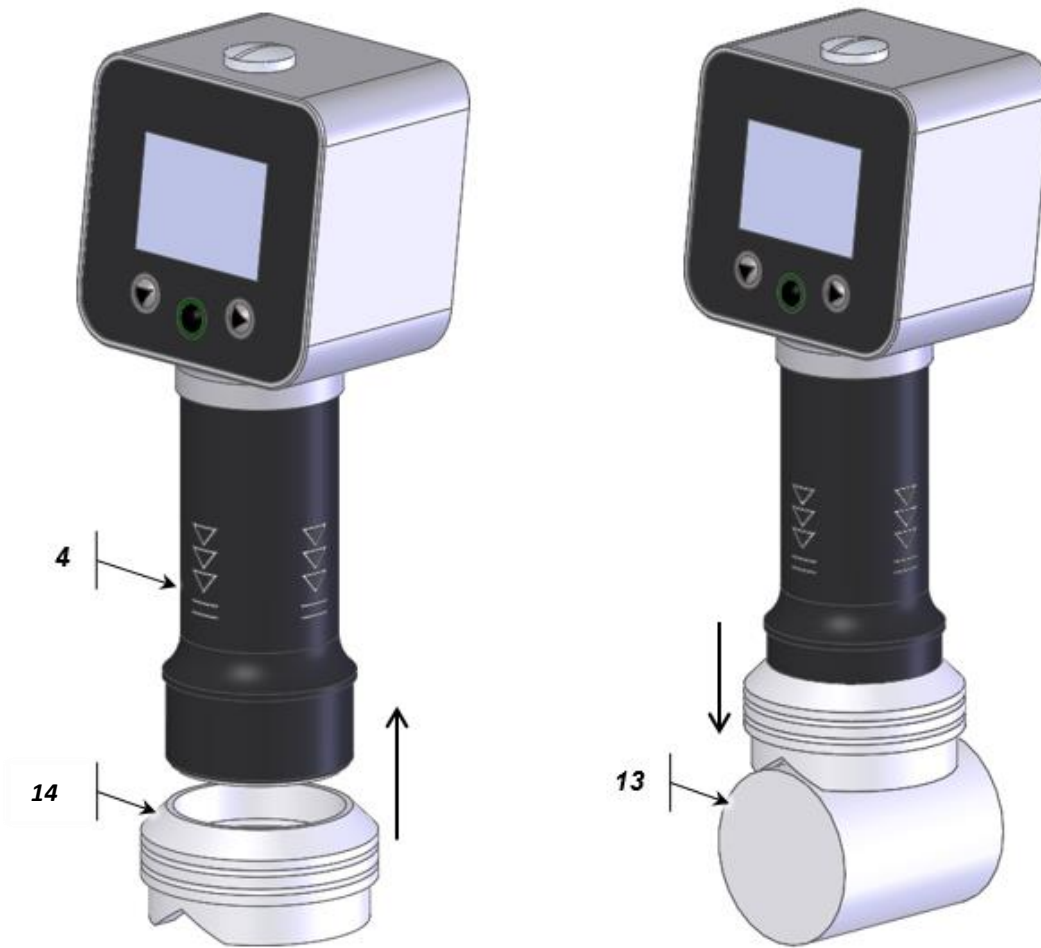
Fig. 12 Montage du prisme,
