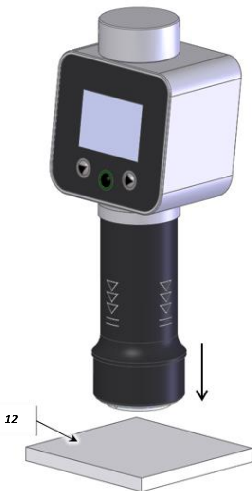
Fig. 13 Essai de dureté Shore 00, 000, 000 S
