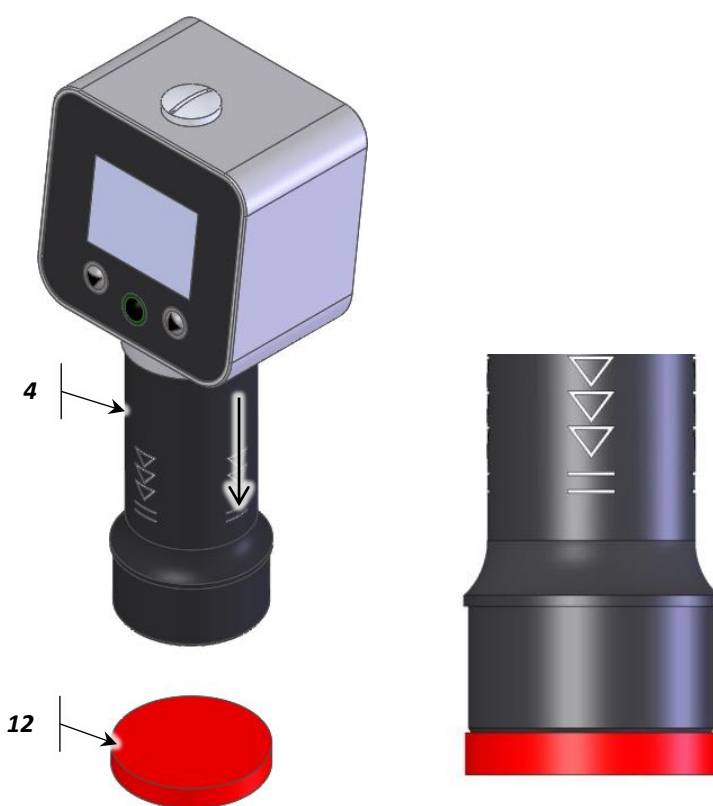
Fig. 11 Essai de dureté Shore A, B, 0, A0, E, L/C, Asker C, Shore D, C, D0
