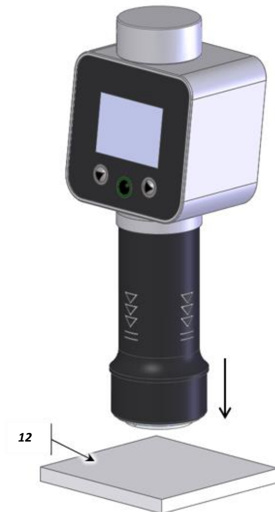
Abb. 13 Härteprüfung Shore 00, 000, 000 S
