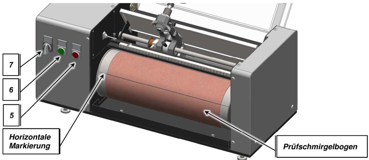
Abbildung 10: Austausch und rüsten des Prüfschmirgelbogens
