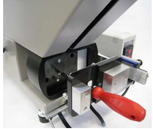
ABB. 7 FESTSCHRAUBEN DES TEMPERIERMODULS MIT AMBOSSPLATTE
