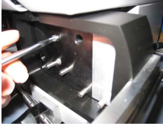
ABB. 7 FESTSCHRAUBEN DES TEMPERIERMODULS MIT AMBOSSPLATTE
