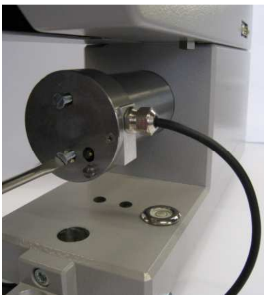
ABB. 6 ENTFERNEN DER AMBOSSPLATTE
