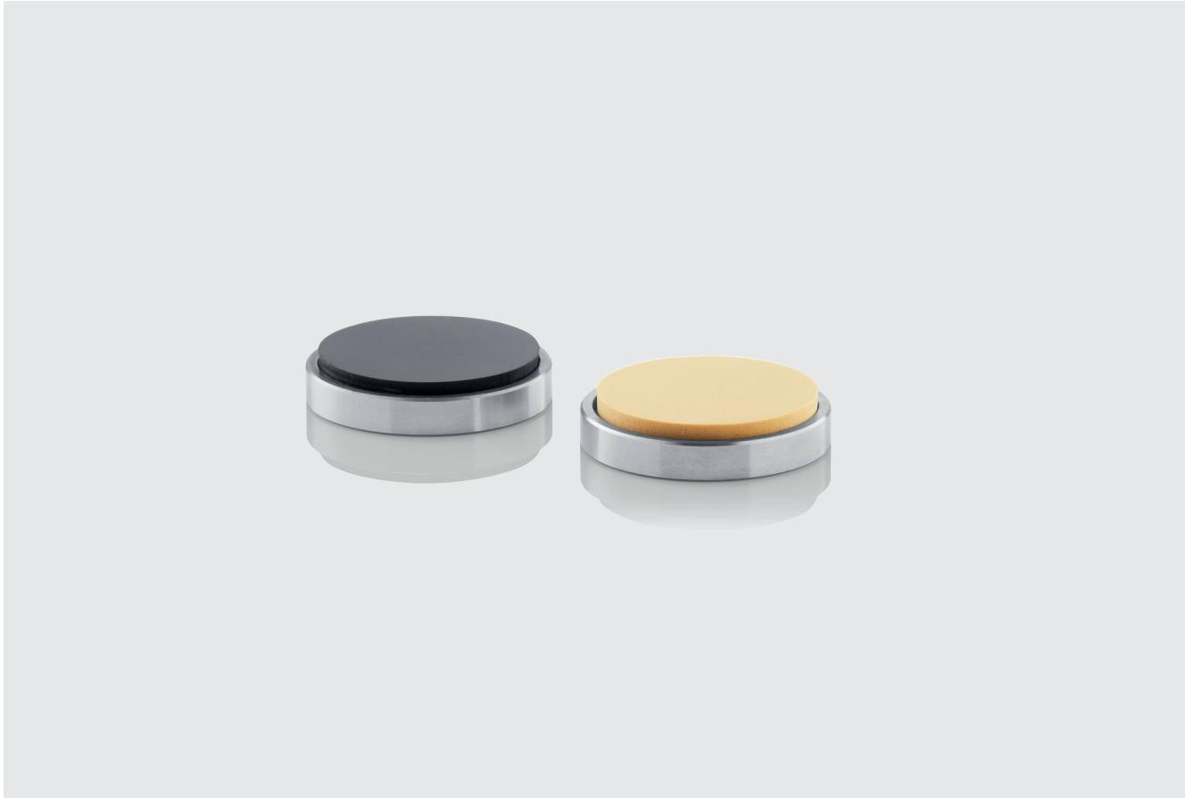
Zwischen den notwendigen Kalibrierintervallen stellen Sie mithilfe der Referenzblöcke die Messfähigkeit des Härteprüfgerätes sicher. Eine Vergleichsmessung an einem der kalibrierten Elastomerprüfkörper gibt Aufschluss über den Zustand des Eindringkörpers und den Messweg des Härteprüfers. Zeigt das Prüfgerät bei der Referenzmessung die korrekte Härte des Referenzelastomers an, so arbeitet es weiterhin zuverlässig.
