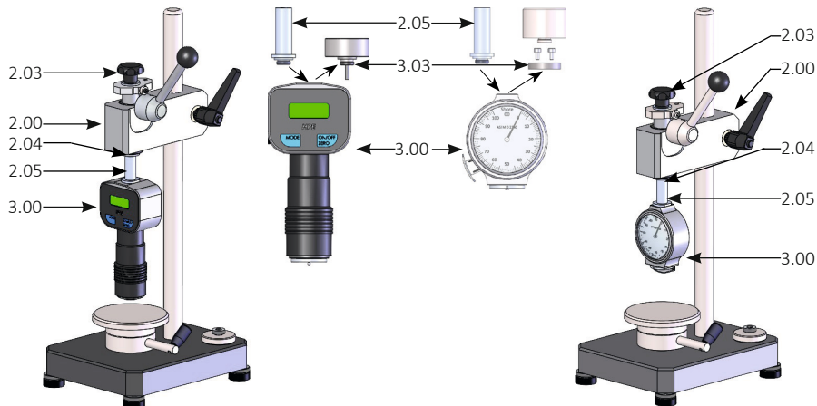
Abb. 3 Montage der Härteprüfgeräte Shore 00, Shore 000, Shore 000 S
