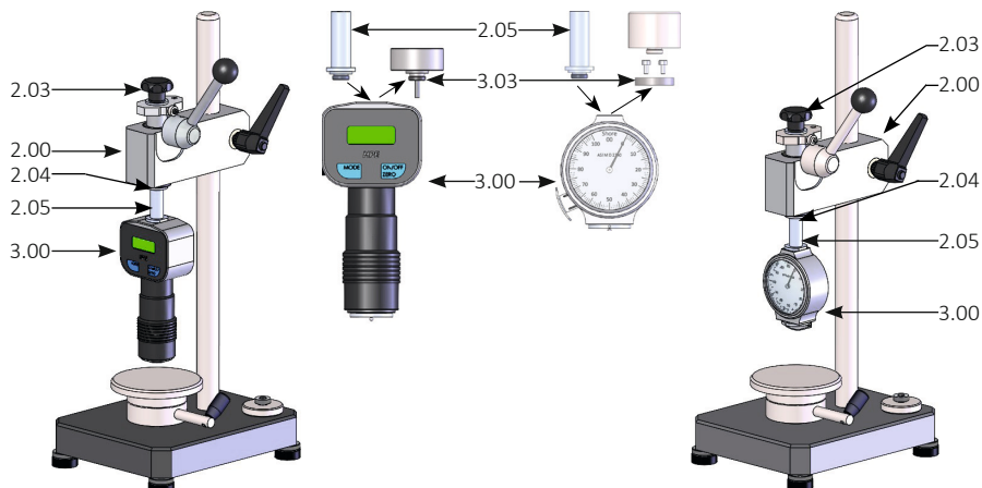
Fig. 3 Montage du duromètre Shore 00, Shore 000, Shore 000 S
