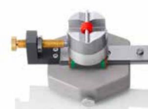
Als Zubehör erhältliche manuelle Positioniereinrichtung zur Messung von einzelnen Probekörpern für das digi test II sowie den Gelomat. Durch modulare Aufsätze auf den Centrofix können Proben und Formteile jeglicher Art eingespannt und für die Messung fixiert werden.
