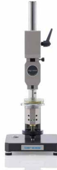
Mit dem Gelomat messen Sie zuverlässig die Festigkeit und Härte von Gelatine, Agar Agar, Gummibärchen, Marmelade, Nährböden oder gallertartigen Stoffen. Verschiedene Messeinrichtungen ermöglichen die Abbildung von einem breiten Spektrum an Lebensmitteln.
