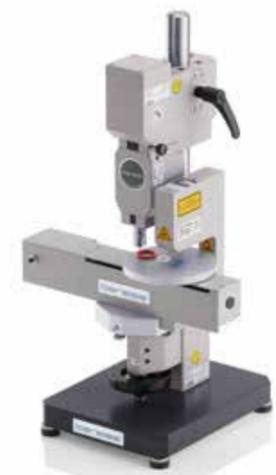
Vollautomatische Positionierung von O-Ringen und Plattenmaterial für die Härteprüfung mit dem digi test II.
